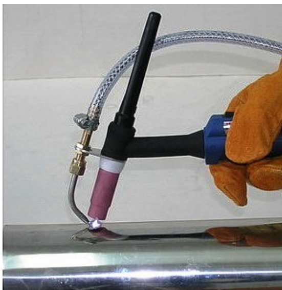
Рисунок 1.3 – Устройство УП4 прецизионной подачи проволоки для ТИГ сварки
