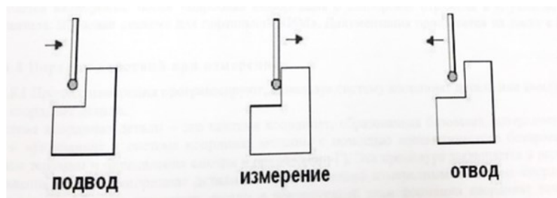
Рисунок 4 – Цикл измерения координат точки
