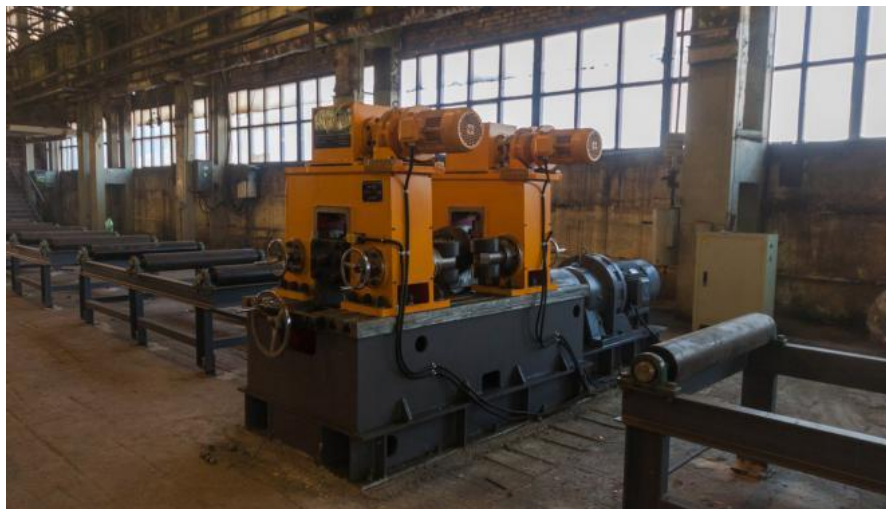
Рисунок 5 - Стан для правки двутавровой балки и швеллера
