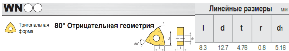
Рисунок 10 – Параметры пластины WNMG080408-НА «KORLOY»
