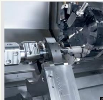
1: Линейный привод, обеспечивающий ускорение в 1g и скорость ускоренного хода 60 м/мин 2: Ось Y с повышенной стабильностью, за счет исключения в варианте согласованного перемещения по осям X и Z 3: Лонет с автоматическим перемещаемым лонетным суппортом обеспечивает безвибрационную обработку деталей большой длины
