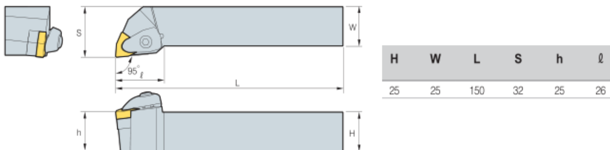
Рисунок 11 – Параметры державки DWLNL2525-M08 «KORLOY»
