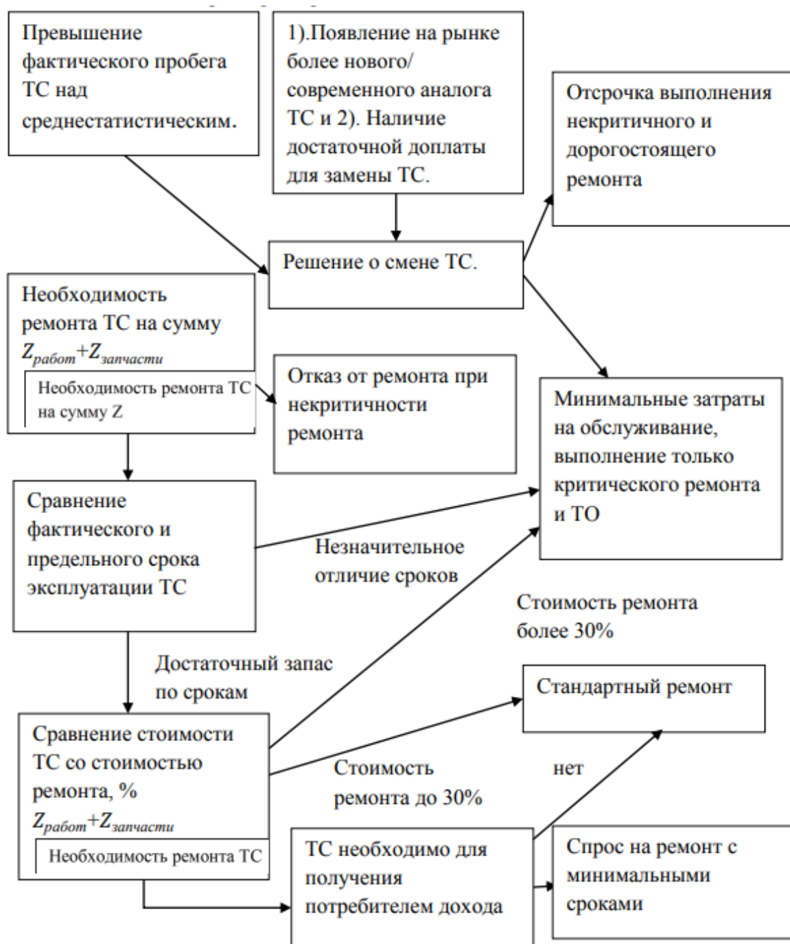
Рис. 2. Алгоритм формирования спроса на услуги ремонта и ТО ТС в зависимости от ряда факторов 15
