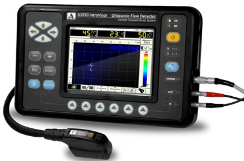
Рисунок 1.16 – Универсальный ультразвуковой дефектоскоп с цифровой фокусировкой антенной решеткой и томографической обработкой данных для контроля металлов и пластмасс A1550 IntroVisor
