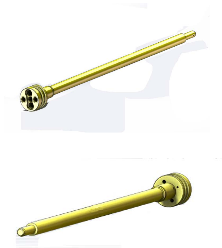
Рисунок 1 – 3D модель детали «Шток накатника»
