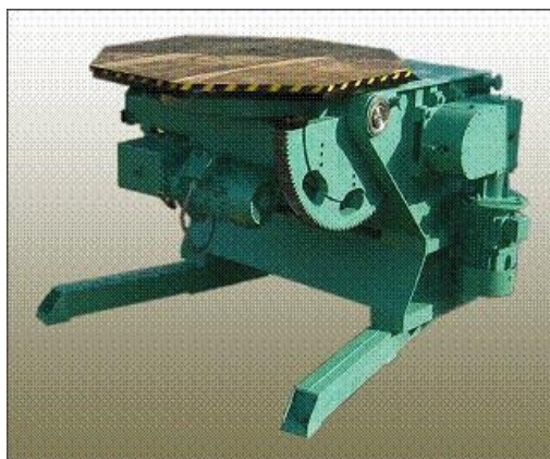
Рисунок 9 - Вращатель универсальный М1108
