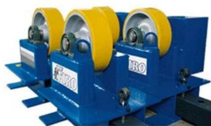
Рисунок 8 - Роликовый вращатель 10TNA
