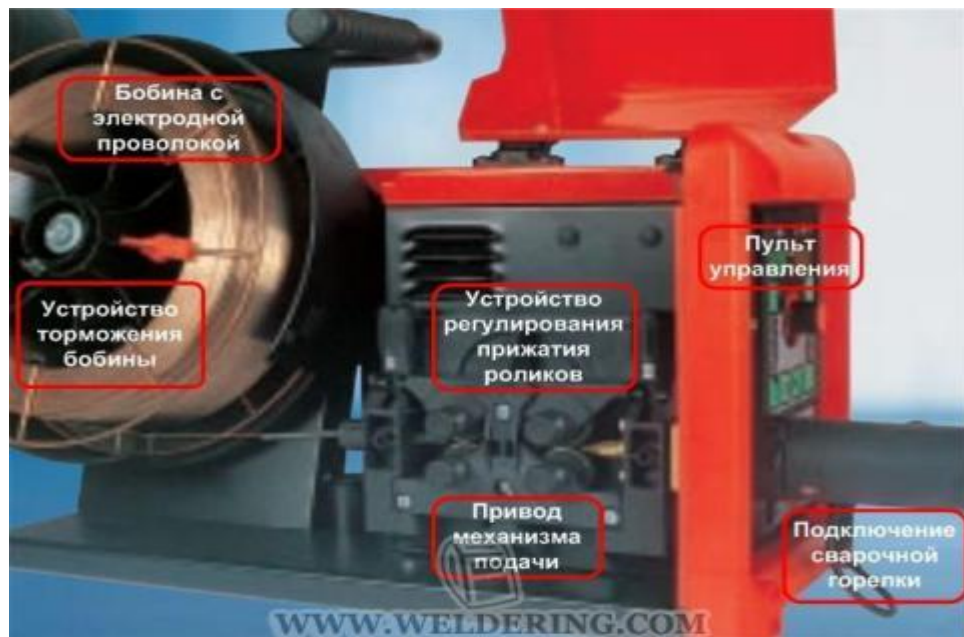
Рис. 3- Основные узлы механизма подачи электродной проволоки
