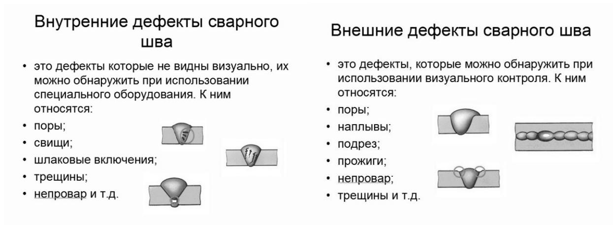
Рис. 3 – Вид слайдов «Внутренние и внешние дефекты сварного шва»
