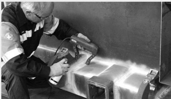
Рис. 7 – Магнитная дефектоскопия
