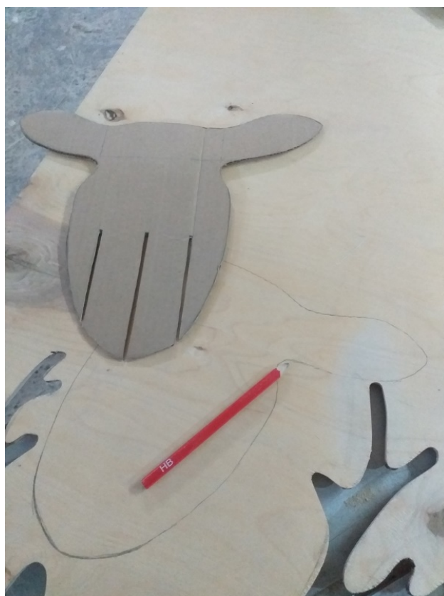
Рис. 9. Раскрой полки на фанере
