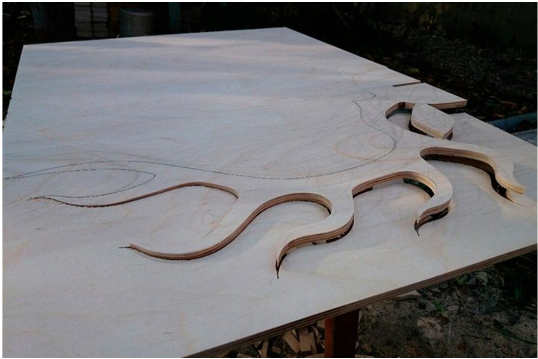
Рис. 10. Распил деталей полки
