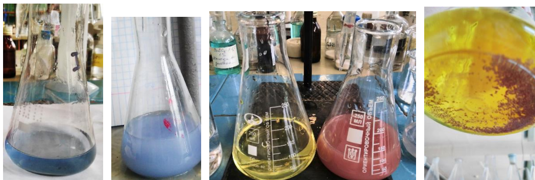
Рис. 2 (слева направо). Оттитрованная проба на сульфаты воды из моря Лаптевых ; воды из Южно-китайского моря; Проба на хлориды воды из моря Лаптевых; воды из Южно-Китайского моря (вид со дна колбы).
