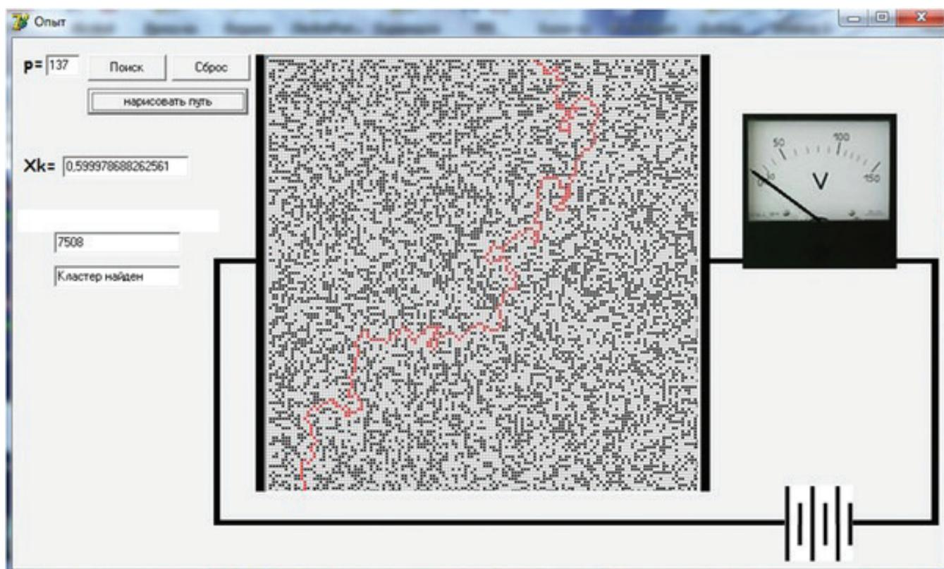
Рис. 1. Компьютерная модель перколяционного процесса в среде Delphi
