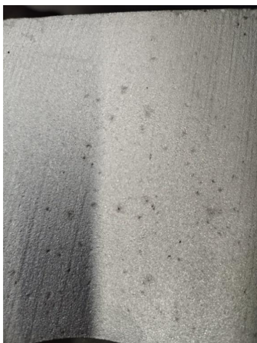
Рис. 3. Поверхность металла при использовании Дегазал Т 200
