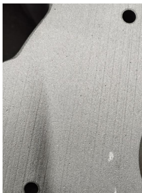
Рис. 4. Поверхность металла при использовании ЛитоФлюс-Т-2-1
