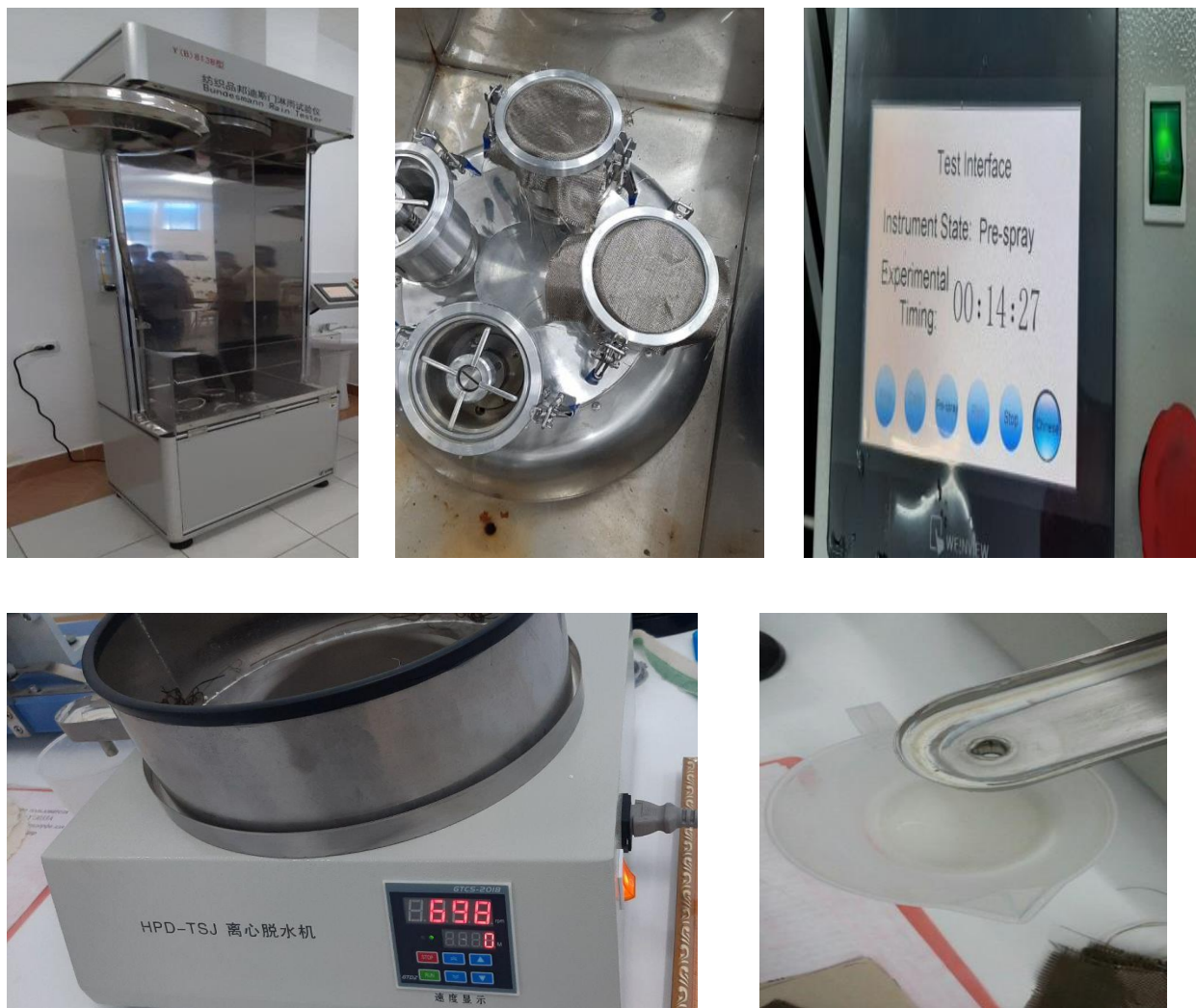
Рис. 3. Определение влагопоглощения ткани
