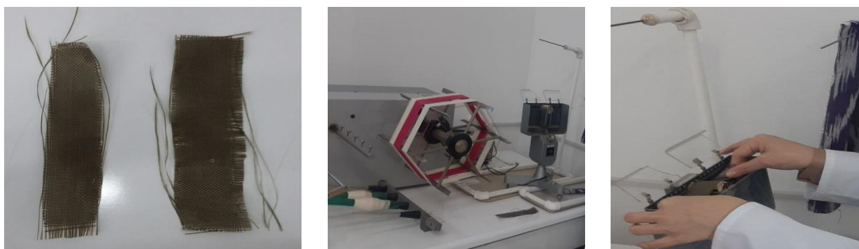
Рис. 4. Определение жесткости полотна при изгибе
