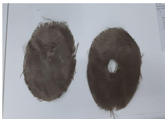
Рис. 1. Определения стойкости полотна к истиранию
