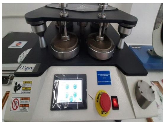
Рис. 1. Определения стойкости полотна к истиранию
