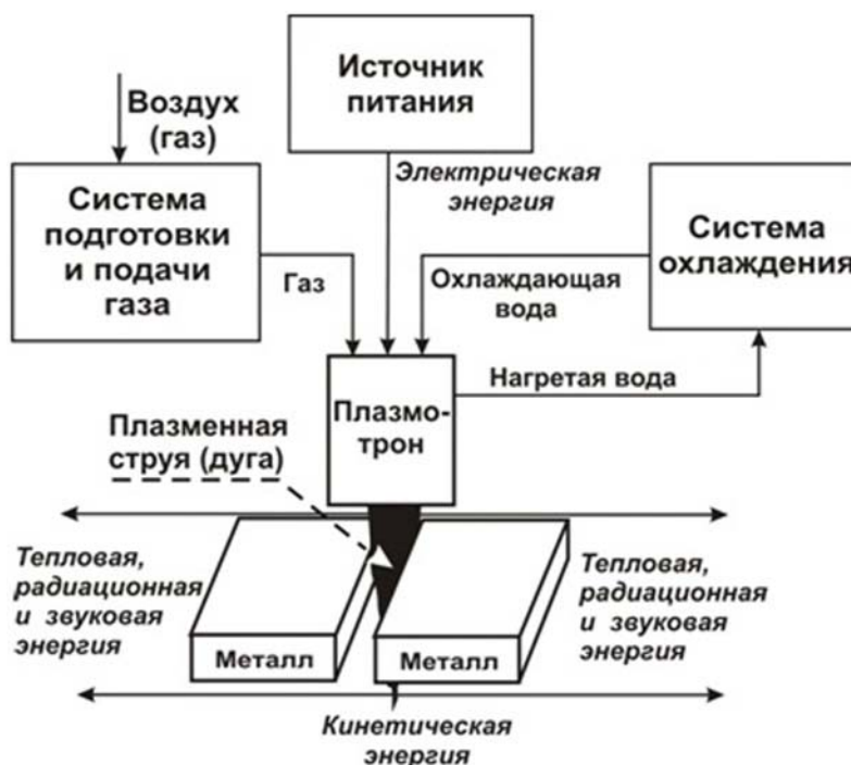
Рис. 3. Материально-энергетическая схема плазменной разделки металлов
