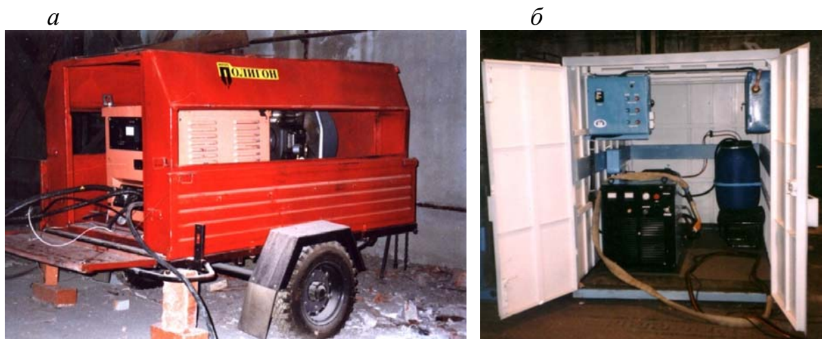
Рис. 56. Транспортируемые модули для плазменной разделки металлообъектов (ООО «НПО Полигон»): а – мобильная установка на базе кунга, б – комплектное рабочее место в перемещаемом контейнерном исполнении
