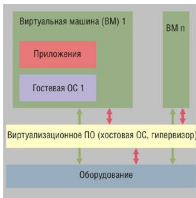
Рис. 9. Принцип работы виртуальной машины
