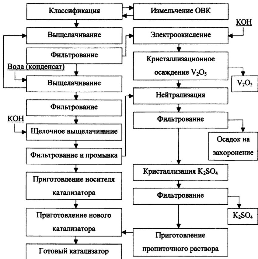
Рис. 1.4. Технологическая схема переработки ОВКСП:
