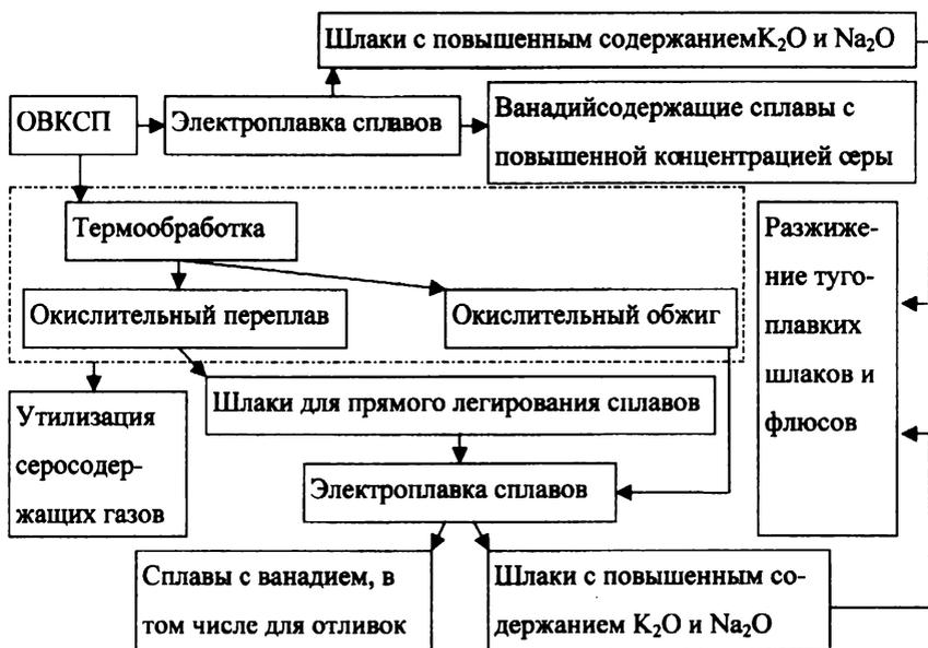
Рис. 1.5. Промежуточная технологическая схема переработки ОВКСР
