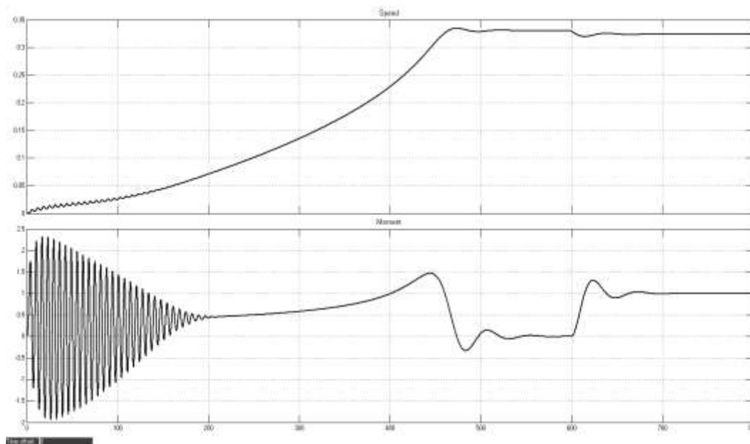
Рис. 1. Результаты моделирования, относительные значения электромагнитного момента и скорости
