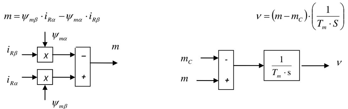
Для моделирования выберем АКЗ со следующими паспортными данными и параметрами [4], [5]:  $P = 320 \text{ кВт}$ ,  $U_1 = 380 \text{ В}$ ,  $I_1 = 324 \text{ А}$ ,  $f = 50 \text{ Гц}$ ,  $p = 3$ ,  $R_s = 0.0178 \text{ Ом}$ ,  $R_r = 0.0194 \text{ Ом}$ ,  $L_{\sigma s} = 0.118 \text{ Ом}$ ,  $L_{\sigma r} = 0.123 \text{ Ом}$ ,  $X_s = 4.67 \text{ Гн}$ ,  $X_r = 4.675 \text{ Гн}$ ,  $X_m = 4.552 \text{ Гн}$ ,  $J = 28 \text{ кг} \cdot \text{м}^2$ .
