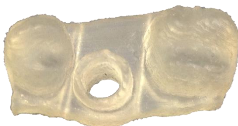
Рисунок 5 – Образец стоматологического шаблона, изготовленный методом быстрого прототипирования
