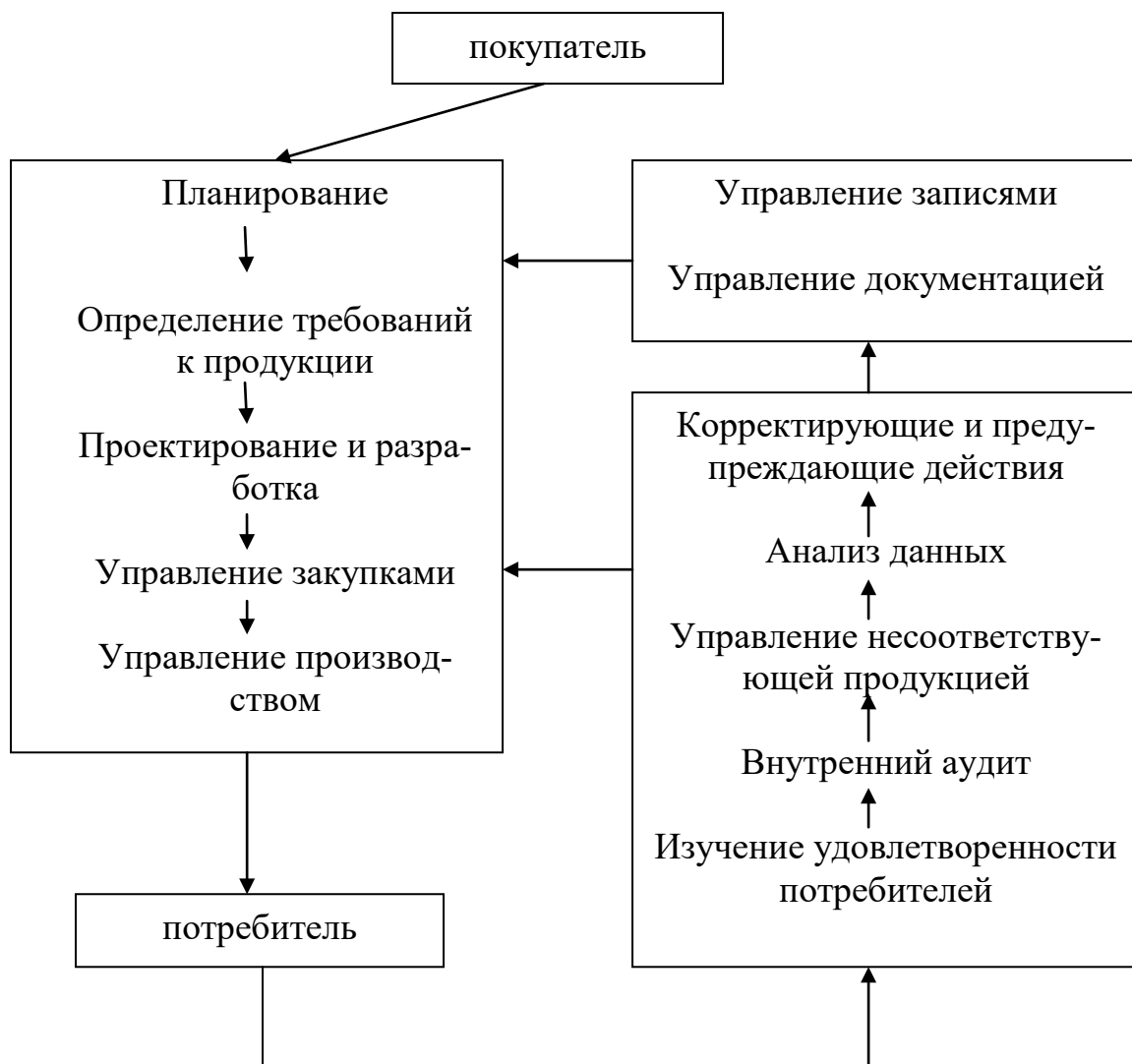
Рисунок 9 – Схема взаимодействия процессов на предприятии ОАО Завод пожарных автомобилей «Спецавтотехника»
