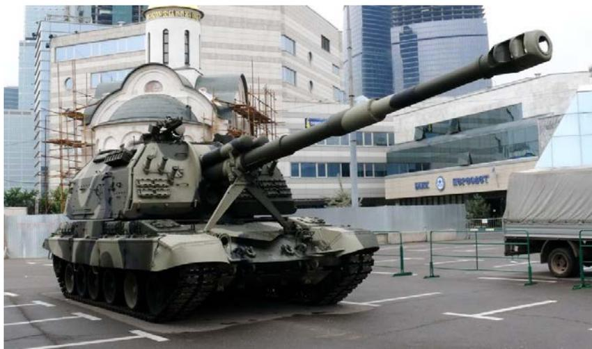
Рисунок 2 – Самоходная артиллерийская установка 2С19 «Мста – С»
