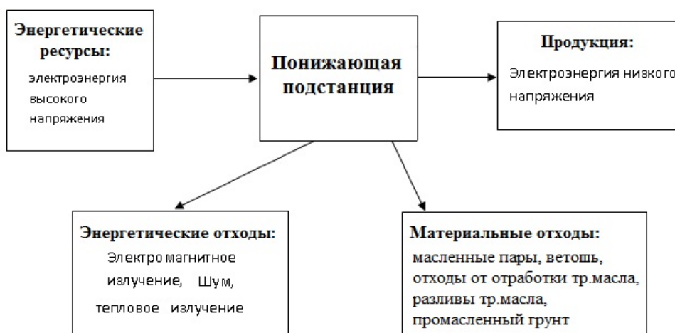
Рисунок 11 - Схема потребления ресурсов и образования отходов при работе подстанции
