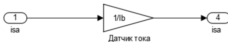
Рисунок 39 - Структурная схема датчика тока
