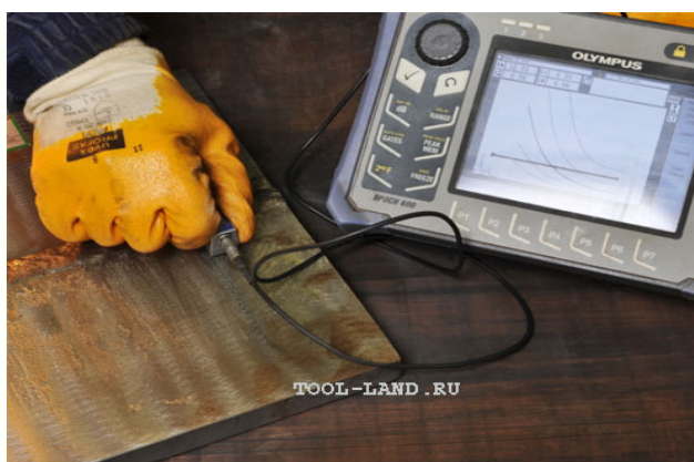
Рисунок 20 – Проверка сварного шва ультразвуковым дефектоскопом
