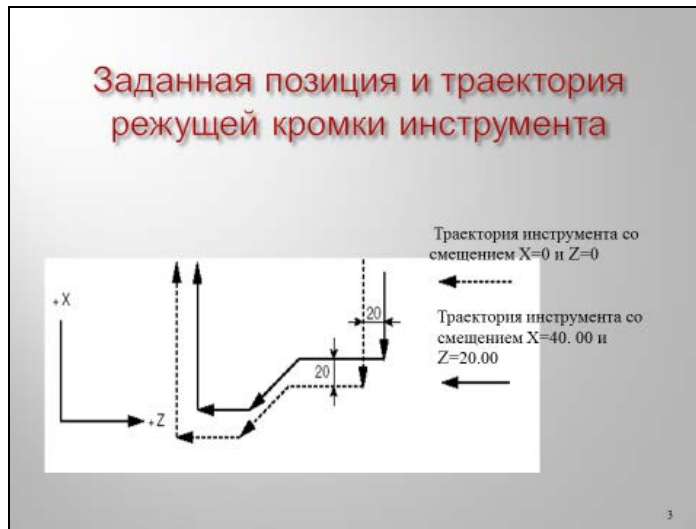
Рисунок 11 - Слайд 3. Траектория режущей кромки
