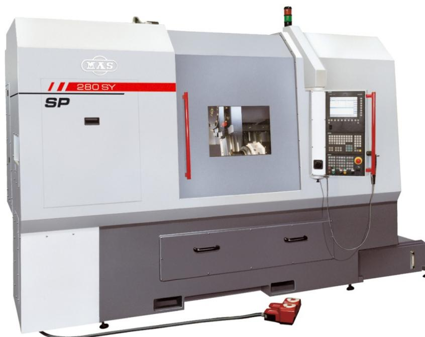
Рисунок 3- Токарный станок с ЧПУ SP 280 SY
