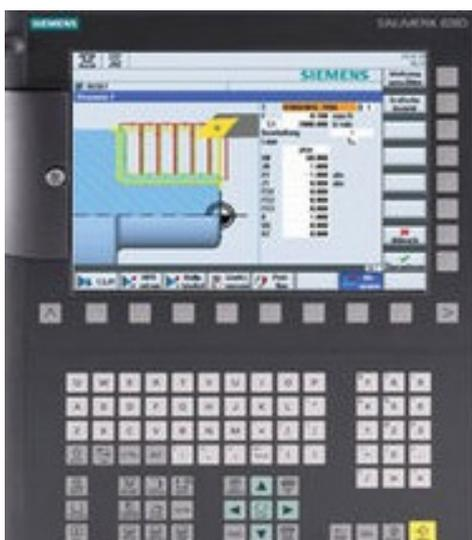
Рисунок 11- Окно стойки с ЧПУ SINUTRAIN
