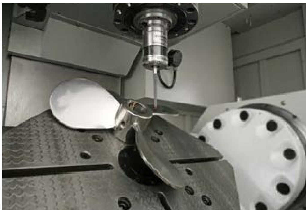
Рисунок 39 – Измерительный щуп. Измерение поверхности детали
