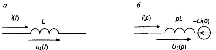
Рис. 5.2. Схема замещения индуктивности в операторной форме:
