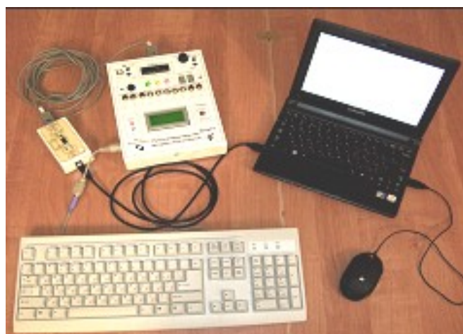
Рис. 3. Учебный микропроцессорный комплекс «AVR» с разработанным универсальным последовательным интерфейсом
