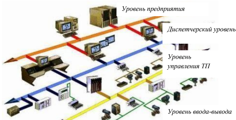
Рис 3. Типовая функциональная схема управления производством
