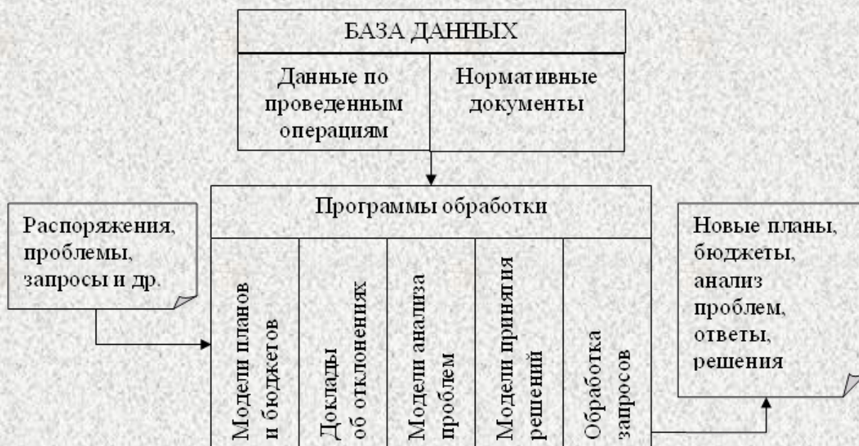
Рис. 4.8. Схема обработки данных на уровне управленческого контроля
