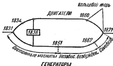
Рис. 3. Схема развития ранних электрических двигателей и генераторов постоянного тока
