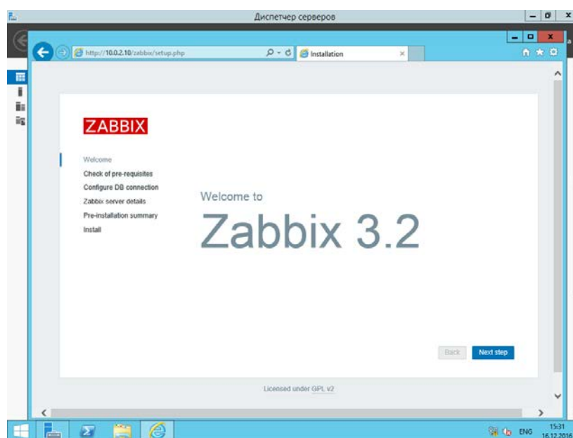
Рисунок 37 — Первый этап установки и настройка сервера «Zabbix» через web-интерфейс
