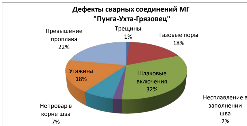
Рисунок 13 - Диаграмма распределения дефектов сварных соединений
