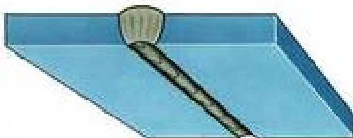
Рисунок 11 - Вогнутость корня шва (утяжина)
