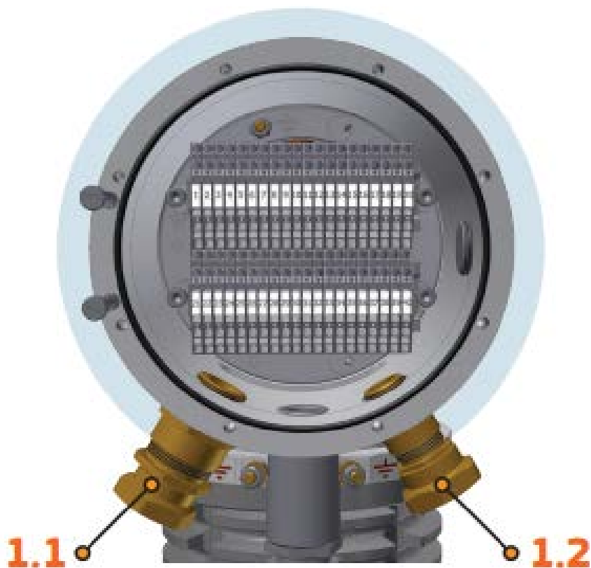
Рисунок 4 - Установка кабельных выводов
