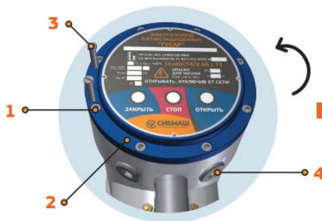
Рисунок 3 - Демонтаж бокса внешних подключений блока
