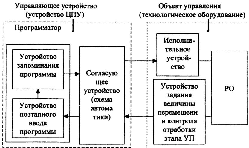
Рис.1.4.Блок – схема системы ЦПУ
