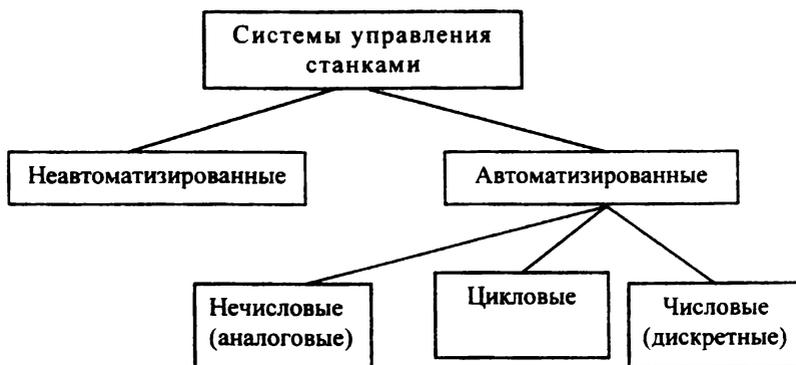
Рис.1.1 Классификация систем управления станками
