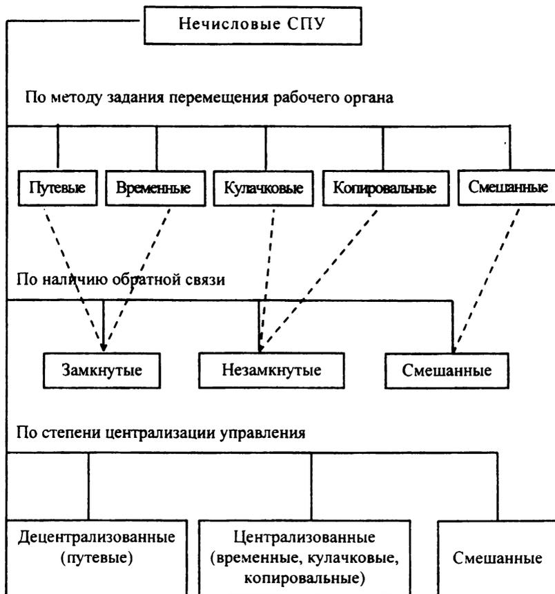
Рис.1.2. Классификация нечисловых систем программного управления станками.
