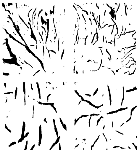
Рис. 2. Крупные и средние неориентированные пластины графита с притупленными краями, разветвленность низкая (после воздействия на морфологию графита), не травлено ( \times 100 )
