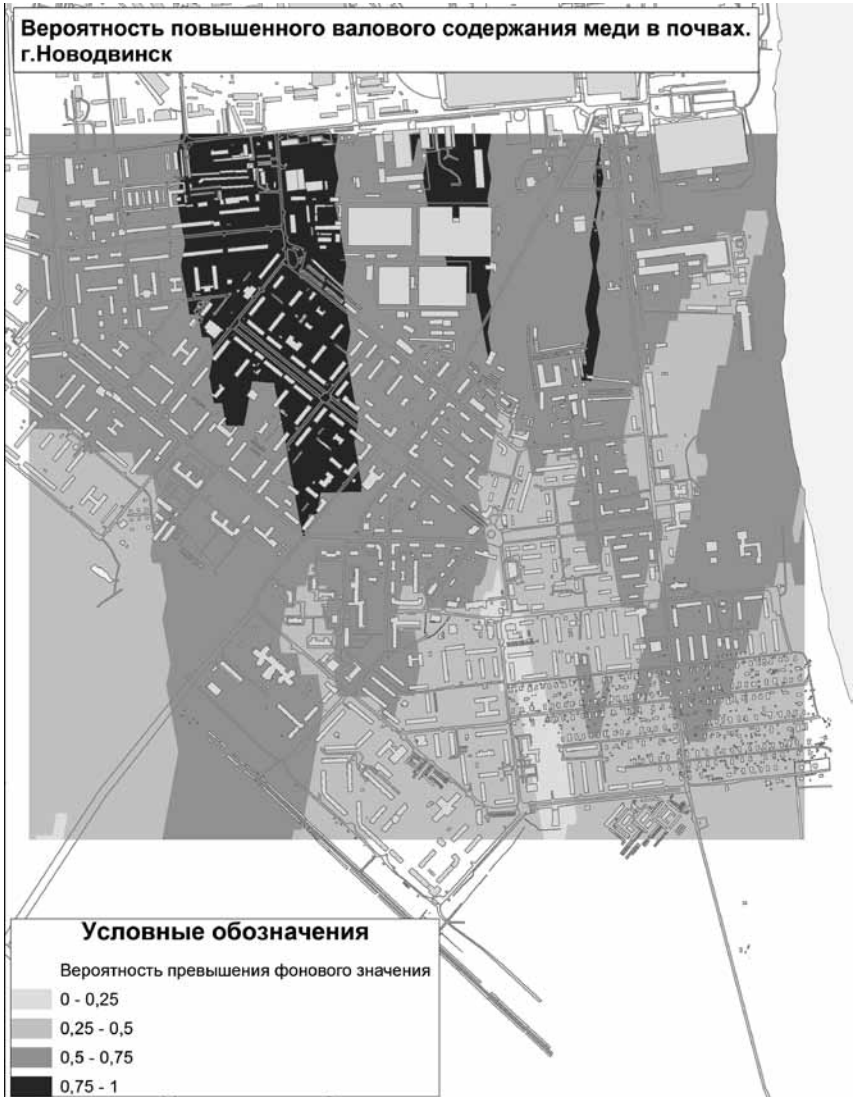
Рис. 7. Тематическая карта вероятностей превышения фонового валового содержания Си в почвах г. Новодвинска
