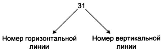
Рис. 12. Пример обозначения основной конструктивной точки
