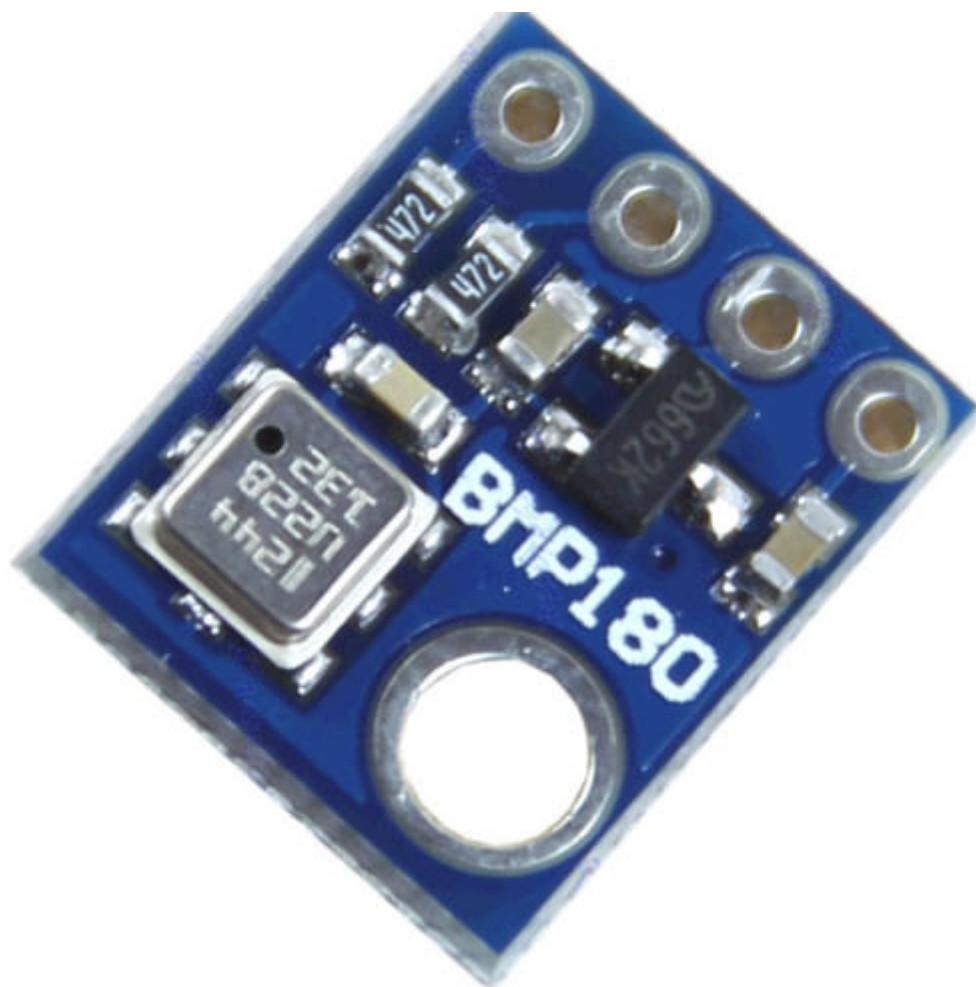
Рисунок 18 – Датчик температуры и давления BMP180
