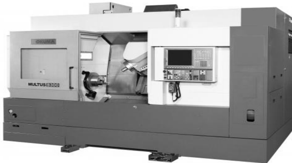
Рисунок 9 – Токарно-фрезерный обрабатывающий центр MULTUS-B300W
