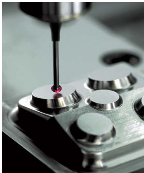
Рисунок 10 – Трехмерный беспроводной измерительный щуп.
