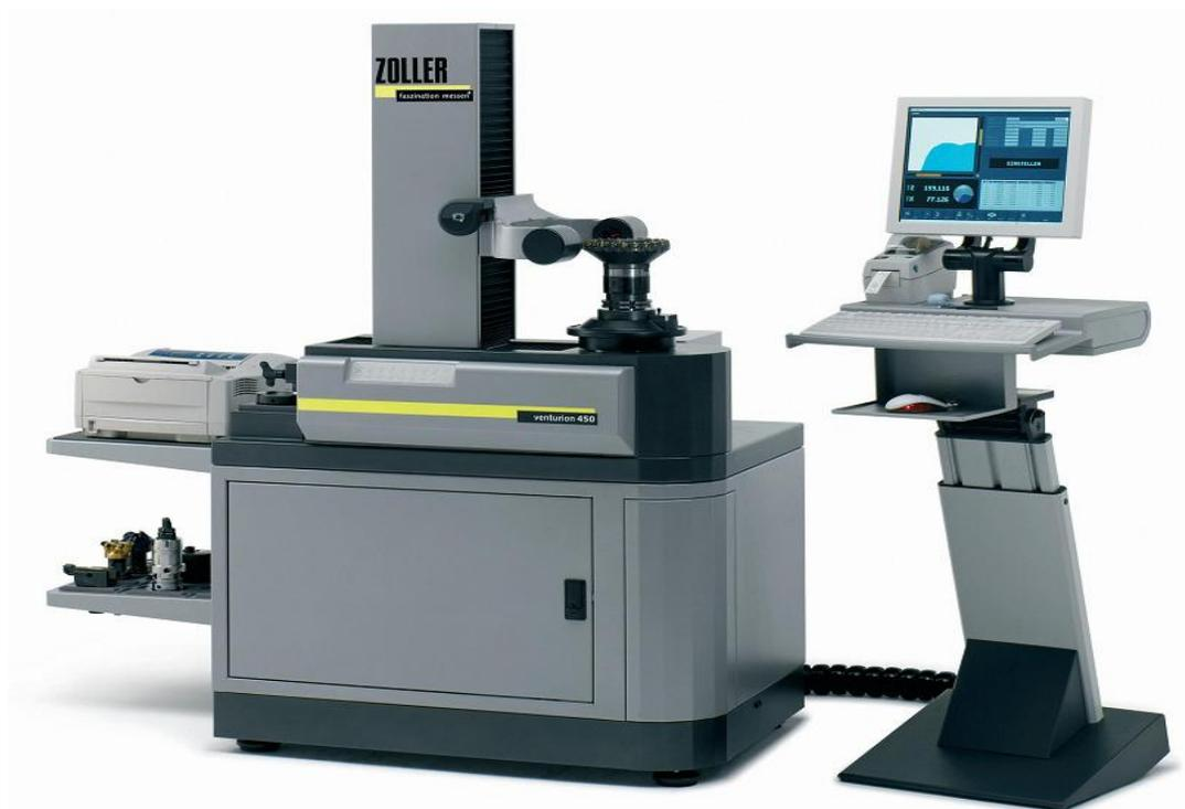
Рисунок 2 – Измерительная машина Zoller «venturion 400/500»
