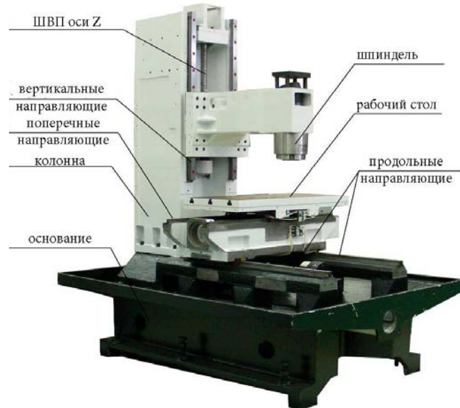
Основные узлы фрезерного станка
