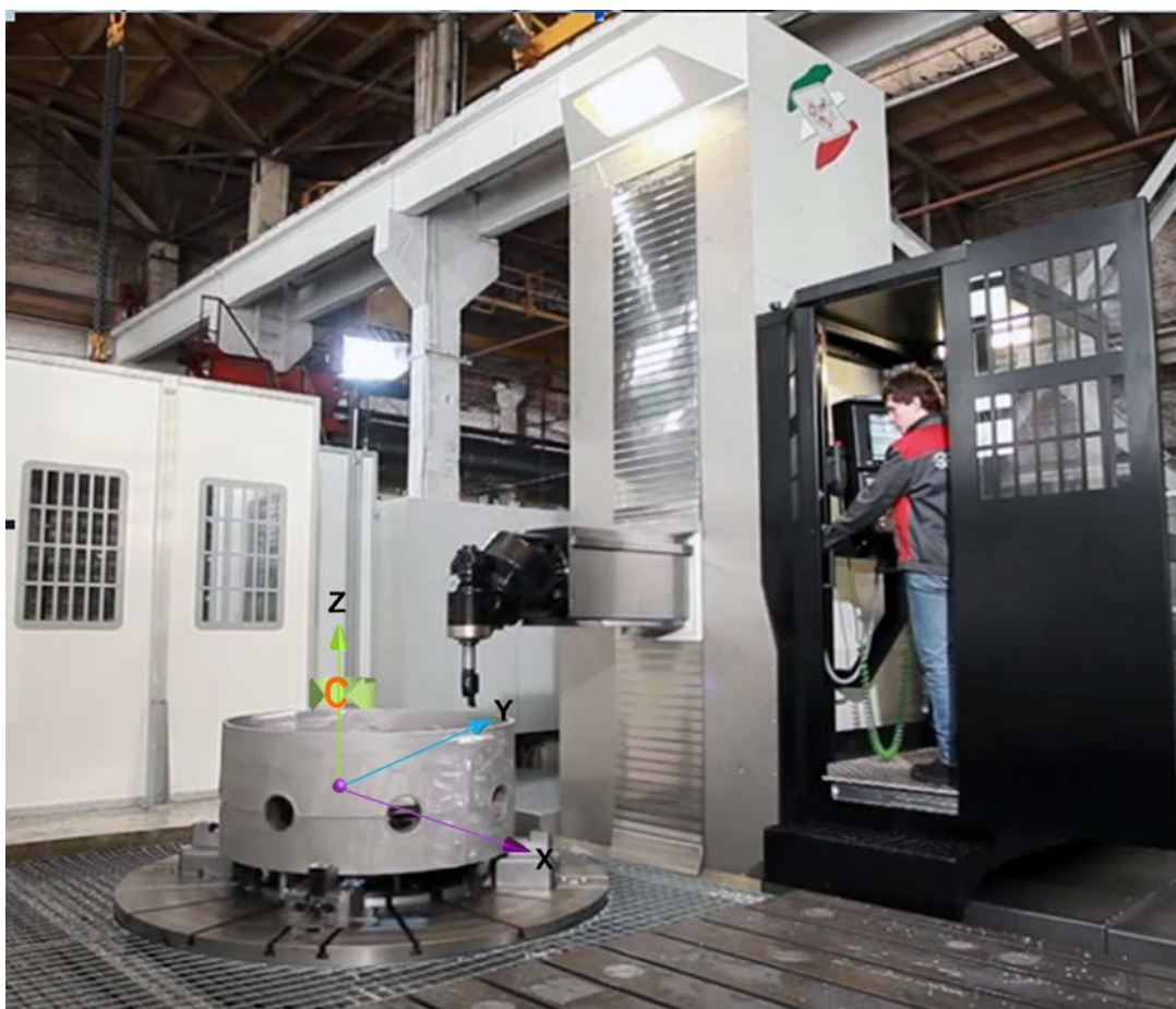
Рисунок 5 – Рабочая зона PARPAS ELECTRA 6000 с расположением осей
