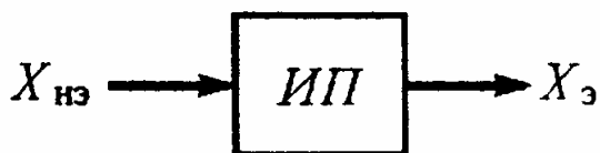
Рис. 9.1. Структурная схема преобразования неэлектрических величин
