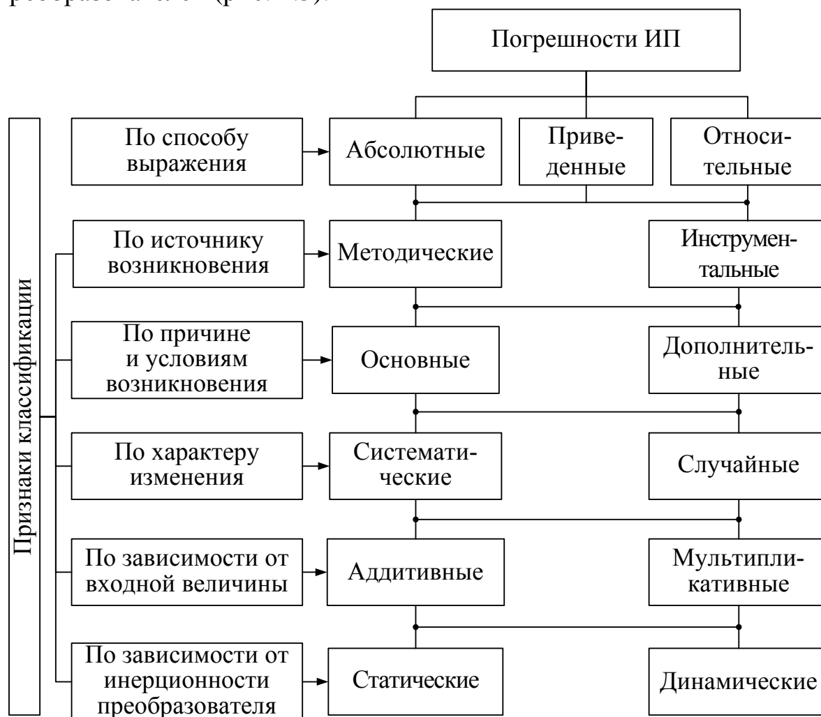
Рис. 4.3. Расширенная классификация погрешностей измерительных приборов и преобразователей
