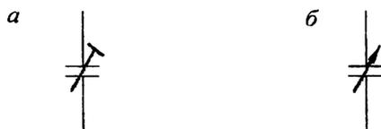
Рис. 3.11. Конденсаторы переменной емкости:
