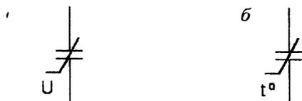
Рис. 3.12. Нелинейные (саморегулирующиеся) конденсаторы:
