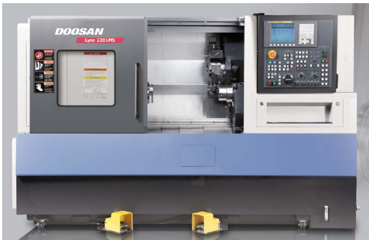
Рисунок 6 – Обрабатывающий центр с ЧПУ модели LYNX 220 LMSA
