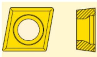
Рисунок 6 - Пластина ССМТ 09Т304 –FF1
